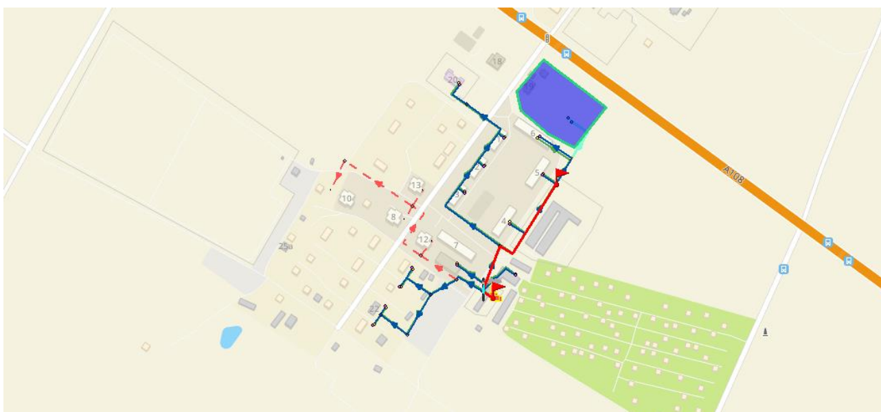
Рисунок 3.80 – Расчетная схема участков тепловой сети от котельной до УТ-3
