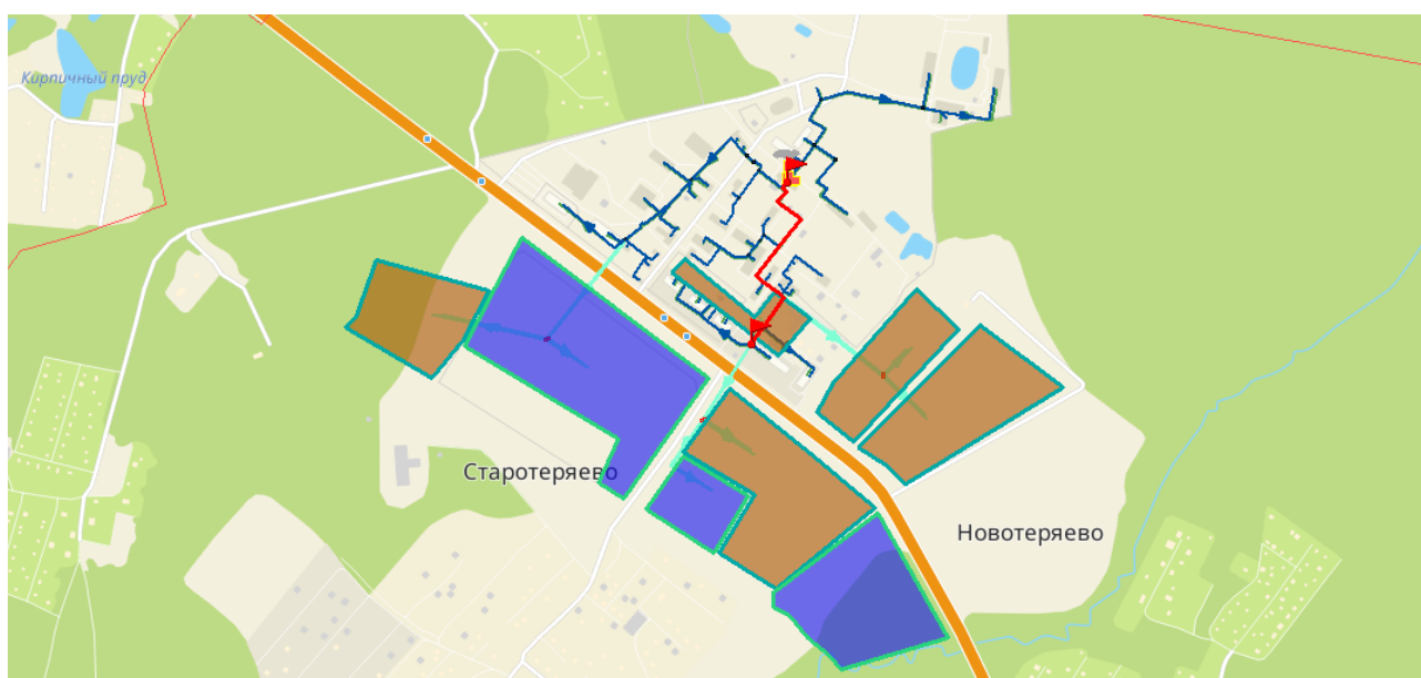
Рисунок 3.82 – Расчетная схема участков тепловой сети от котельной до ТК-9
