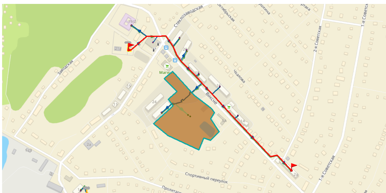
Рисунок 3.88 – Расчетная схема участков тепловой сети от котельной до ул. Вискне 2а
